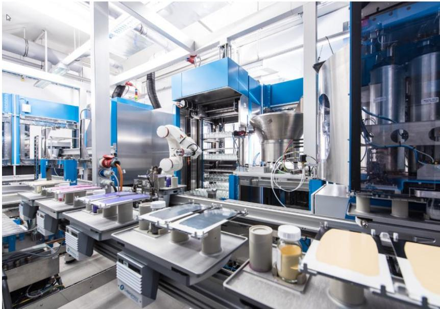
**Bildunterschrift:** Kann pro Tag 120 Proben formulieren und testen: die neue Hochdurchsatz-Anlage in Essen.
